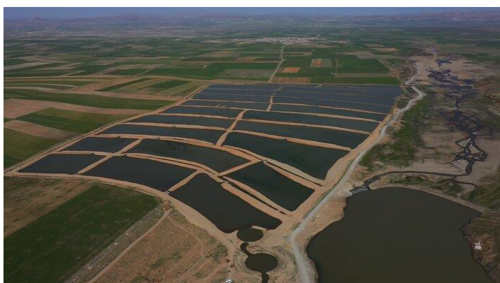
شکل ۱- نمایی از سامانه‌های پخش سیلاب شامل کانال‌های هدایت و حوضچه‌های ته‌نشینی.
